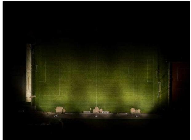
Das linke Bild zeigt den Fussballplatz mit 120-Lux-Stufe beleuchtet. Für den Trainingsbetrieb kann die Beleuchtung auf 80 Lux gedimmt werden. Zusätzlich ist es in der Trainingsstufe möglich, die bachnahe Platzhälfte auszuschalten, so dass kein Licht mehr zum angrenzenden Bachbereich gelangt.
