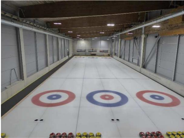
In der Curlinghalle sind im House-Bereich 400 Lux und im Rink-Bereich 250 Lux jeweils bei einer Gleichmässigkeit von  $E_{\min}/E_m \geq 0.7$  gefordert.
