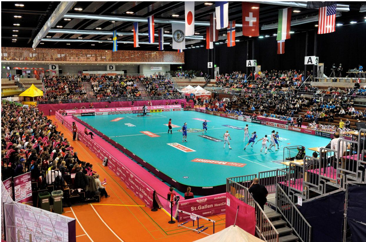
Die Sporthallenbeleuchtung bestand bisher aus 192 Hallenleuchten (Halogen-Metalldampf-Lampen HIT 400 W) und einer zusätzlichen TV-Beleuchtung mit 60 Scheinwerfern (HIT-DE 1000 W).
